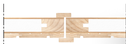
Horizontalsnitt slagport träregelstomme, (inre)
