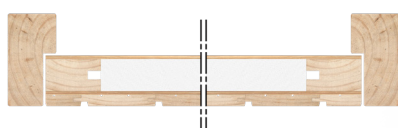
Horizontalsnitt förrådsdörr (yttre)
