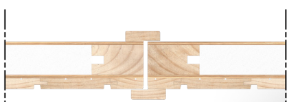
Horizontalsnitt slagport träregelstomme, (inre)
