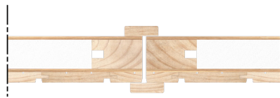
Horizontalsnitt slagport träregelstomme, (inre)
